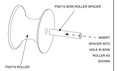
FIGURE 1. ASSEMBLING SPACER INTO ROLLER
