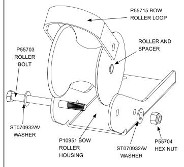
FIGURE 2. ASSEMBLING ROLLER INTO HOUSING
